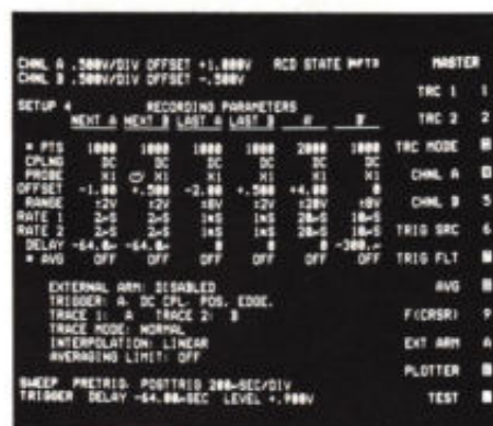
Afb. 2. Het statusdisplay geeft aan welke parameters tijdens de laatste opnamen werden gebruikt en welke tijdens de eerstvolgende opname zullen worden gebruikt.
